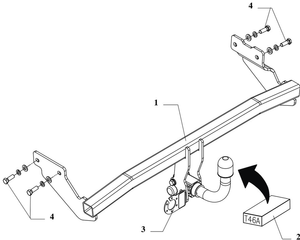
Die Anhängerkupplung (Katalognummer **T46A**) ist für folgende Fahrzeugtypen zugelassen: **KIA PICANTO 3/5 Tüer**, ab Bj. 2003 bis 04.2011, dient zum ziehen der Anhänger mit der Gesamtlast von **700 kg** und der Kugelstützlast von max. **28 kg**.
